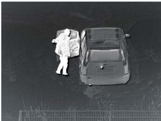
Personenüberwachung mittels Thermografie
